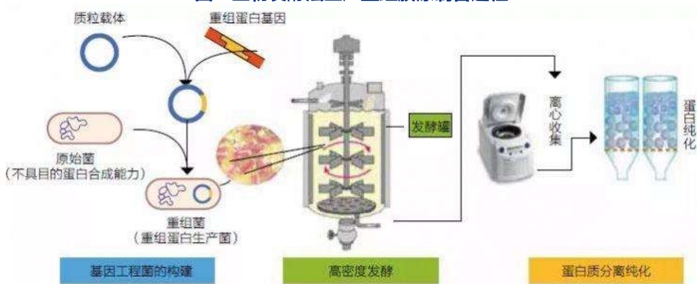
图：生物发酵法生产重组胶原制备过程
